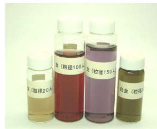
金溶液の色：粒径（金） 20 Å (2 nm)、100 Å (10 nm) 、150 Å (15 nm)、白金
