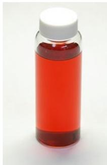
まず、色の濃さはどのようにして測定するかを説明します。可視吸収スペクトルを用います。色素の溶液を石英の容器（長さ1cm、一般のガラスやプラスチックでは紫外線が吸収されるので、吸収の無い石英を使います）に入れて光を当て、色素溶液を透過して出てきた光の強さを測定します。入射光を $I_0$ 、透過光を $I$ としますと、吸光度（A）は、 $A = \log(I_0/I)$ と定義します。いろんな波長の光を当てて吸光度を測定すると、吸収スペクトルが得られます。吸光度の最も高くなる波長を、最大吸収波長（ $\lambda_{max}$ ）といいます。色素の濃度が高いと吸光度は高くなるので、吸光度は色素濃度の目安になります。
