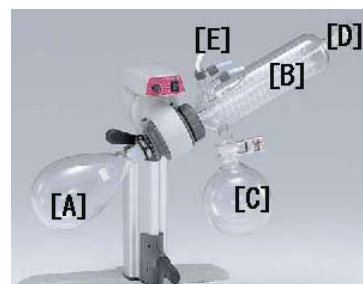
ロータリー・エバポレーター
